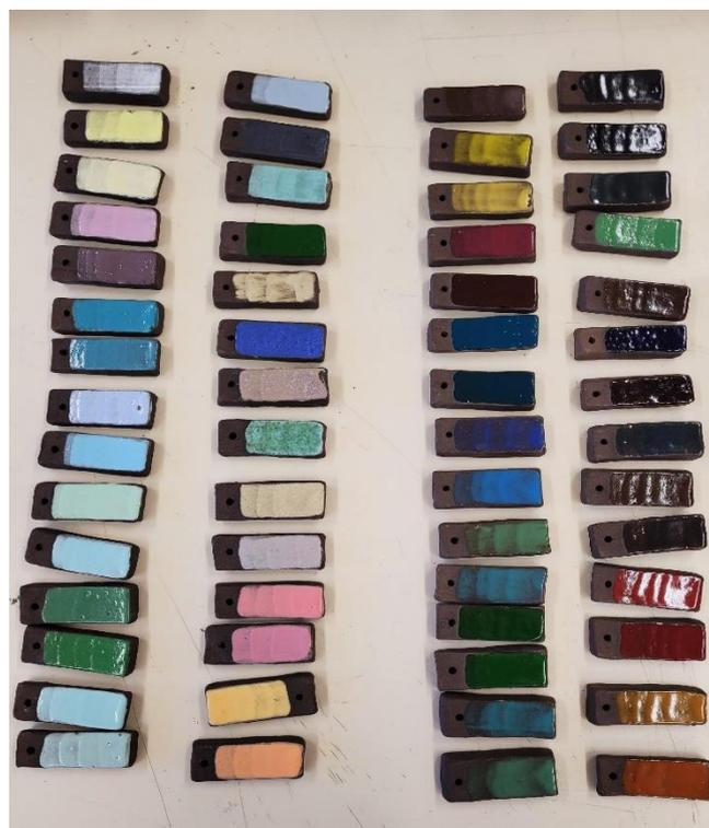
**Abbildung 267:** Schwarze Tonproben nach dem Brand bei 1050°C (Quelle: Berit Ertakuş)
