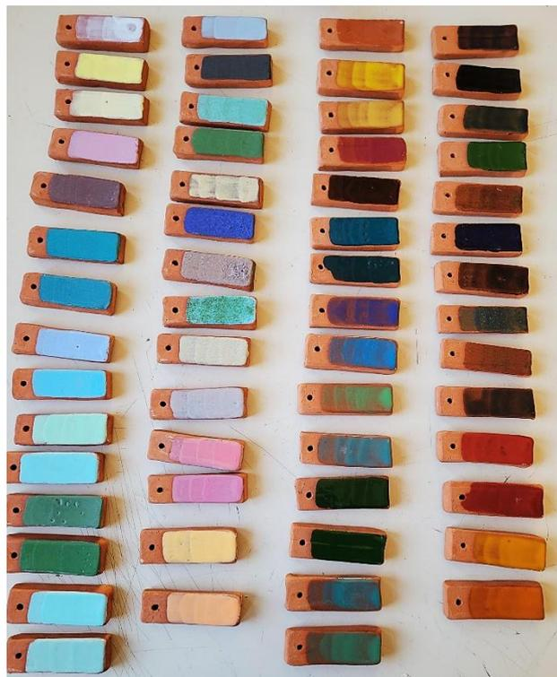
**Abbildung 265:** Rote Tonproben nach dem Brand bei 1050°C (Quelle: Berit Ertakuş)
