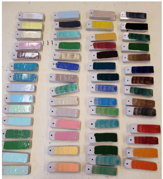
**Abbildung 263:** Graue Tonproben nach dem Brand bei 1050°C (Quelle: Berit Ertakuş)
